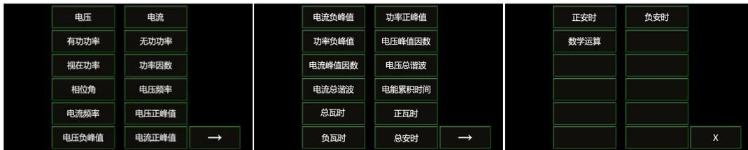
点击 **→** 按钮进行翻页，选择并点击相应的功能显示后自动关闭对话框，或按最后一页的 **X** 按钮关闭对话框。然后按 **系统** 键返回上一级，或按 **测试** 键直接跳转测试界面。
