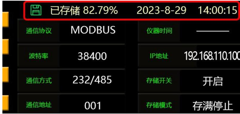
按面板右侧的 **系统** 键，跳转至系统设置界面，找到存储模式选项，设置需要的存储模式，储存模式共分为两种：存满停止和存满覆盖
