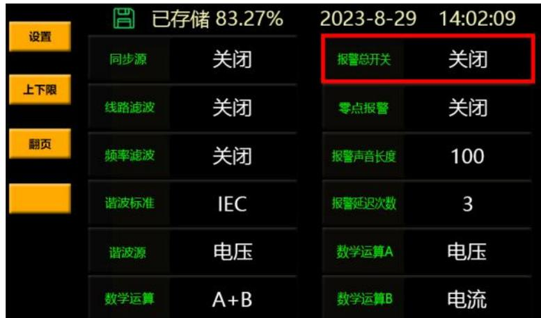
然后再点击 **上下限** 键，跳转至上下限设置界面，设置需要报警的电参数上下限并打开开关。如下图所示
