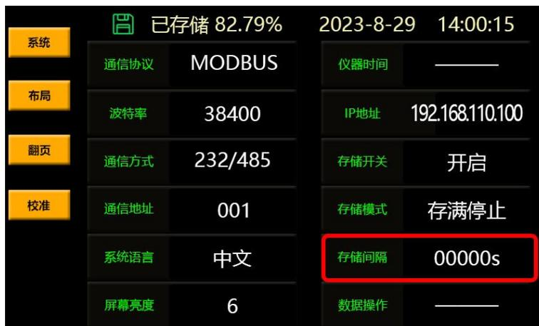
按面板右侧的 **系统** 键，跳转至系统设置界面，找到存储开关选项，选择设置储存开关
