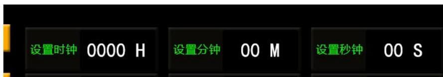
分别设置后点击屏幕左侧的 **开始** 键，开始进行积分测量，累计到预设时间后会自动停止。
