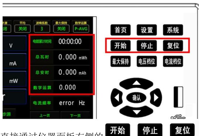
然后直接通过仪器面板右侧的 **开始** **停止** **复位** 键来控制自动积分和手动积分的测试状态。
