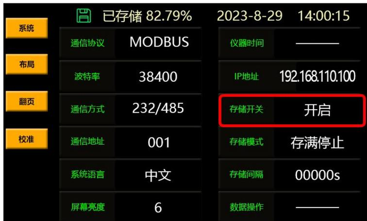
储存开关开启后仪器开始储存数据，储存状态会在系统界面的上方显示，如下图所示
