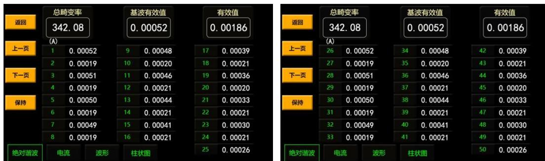
如上图所示为谐波测量的数据界面，可测谐波 1-50 次，按屏幕左侧的 **上一页**、**下一页** 切换分次谐波的参数显示界面。
