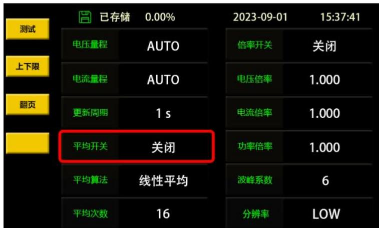
平均开关是否打开，测试界面的状态栏上有相应的指示。如下图所示
