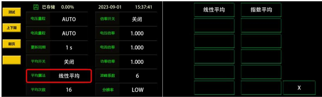
电压、电流、功率等基本参数可以直接平均。其他使用这些功能计算的功能也会受平均影响。用 Urms、Irms、P、S 和 Q 的平均值计算  $\lambda$ 、 $\Phi$ ，设好平均系数后(衰减常数或平均个数)，选择是否设置平均。默认设置是关闭。先点击面板右侧的设置 **设置** 键，再找到平均开关选项，选择打开或关闭，如下图所示
