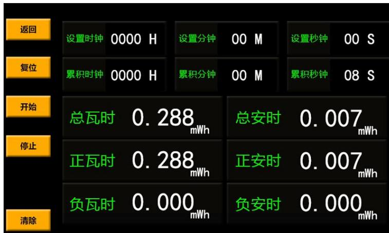
积分功能分为两种，即功率积分和电流积分，积分模式分为自动积分和手动积分两种。
