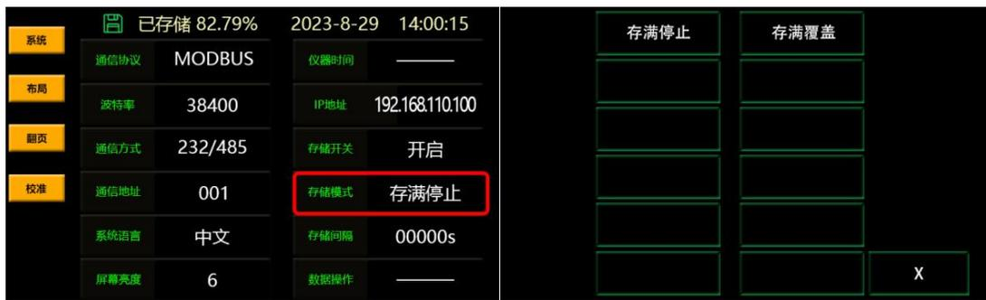
当测试完成需要导出数据时，先在前面板的 USB 接口接入 U 盘，然后按面板右侧的 **系统** 键，跳转至系统设置界面，找到数据操作选项，进入并选择导出，导出完成后可选择重置清除历史数据。如下图所示
